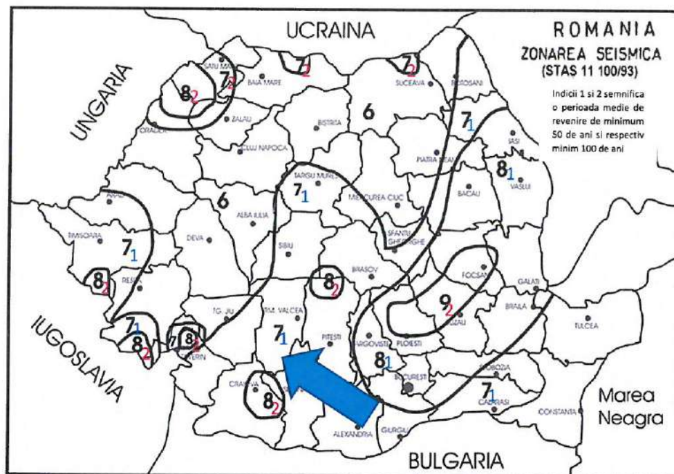
Fig. 7 – Zonarea Teritoriului din punct de vedere seismic
